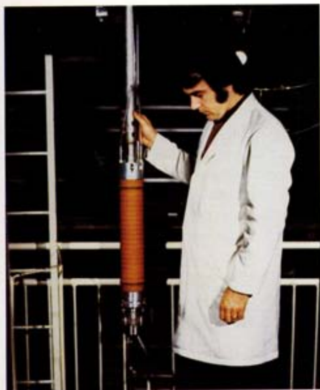
Fig. 50 - L'apparecchiatura DIC (Difettoscopia Integrale Canali), utilizzata per effettuare repliche mediante elastomeri al silicone dello stato superficiale interno di tratti anche estesi di tubi a pressione.
