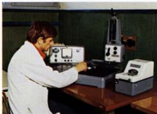
Fig. 70 - Apparecchiatura Talysurf per la determinazione della rugosità e del profilo di superfici, impiegata per la caratterizzazione di campioni di materiali per prove di corrosione, per la determinazione di corrosioni localizzate sui campioni (fretting corrosion), per la qualificazione di manufatti (ad esempio, tubi a pressione del CIRENE), etc.
