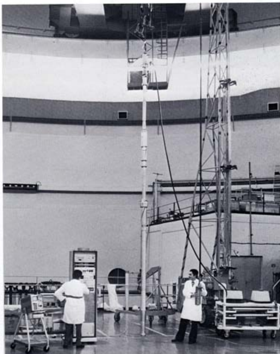
Fig. 49 - L'apparecchiatura UMOR (Unità di Misura ORenda), per l'ispezione in reattore della superficie interna di tubi a pressione: essa assicura il posizionamento di una testa di misura dotata di trasduttori di spostamento in grado di rilevare con estrema accuratezza eventuali deformazioni diametrali e difetti superficiali. A sinistra nella foto è visibile il sistema automatico per l'acquisizione dei dati, che vengono successivamente elaborati mediante calcolatore. La testa di misura è situata all'interno del tratto inferiore dell'apparecchiatura.
