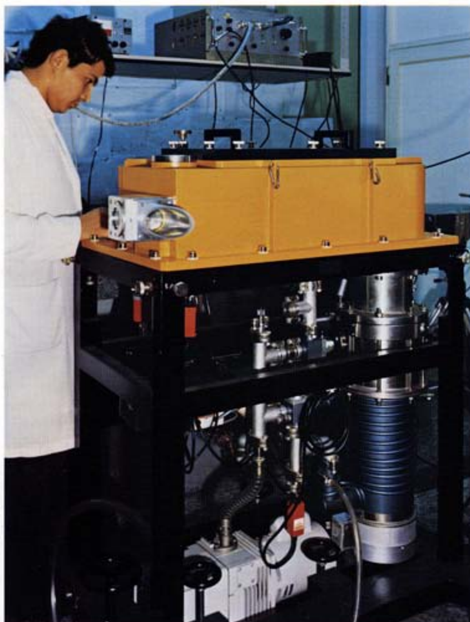
Fig. 104 - Spettrografo per radiazione ultravioletta e X, con possibilità di scansione fotoelettrica nella regione dello spettro compresa tra 10 e 900 Å. È impiegato per l'analisi della distribuzione spettrale della radiazione emessa dal plasma generato nell'esperienza illustrata nella fig. 101.
