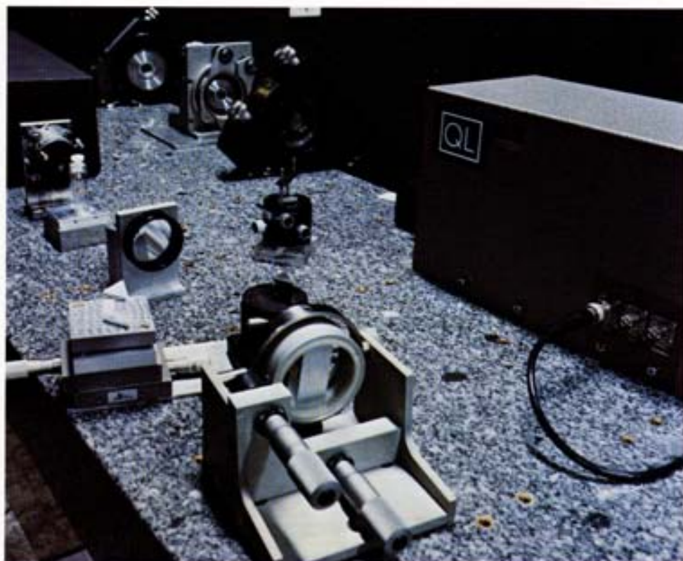
Fig. 103 - Otturatore rapido ad effetto Kerr ottico per l'analisi di impulsi di luce nella scala dei ps. Ha il medesimo impiego dell'apparecchio mostrato nella fig. precedente. La tecnica usata è però diversa e le informazioni ottenute sono sotto molti aspetti complementari.
