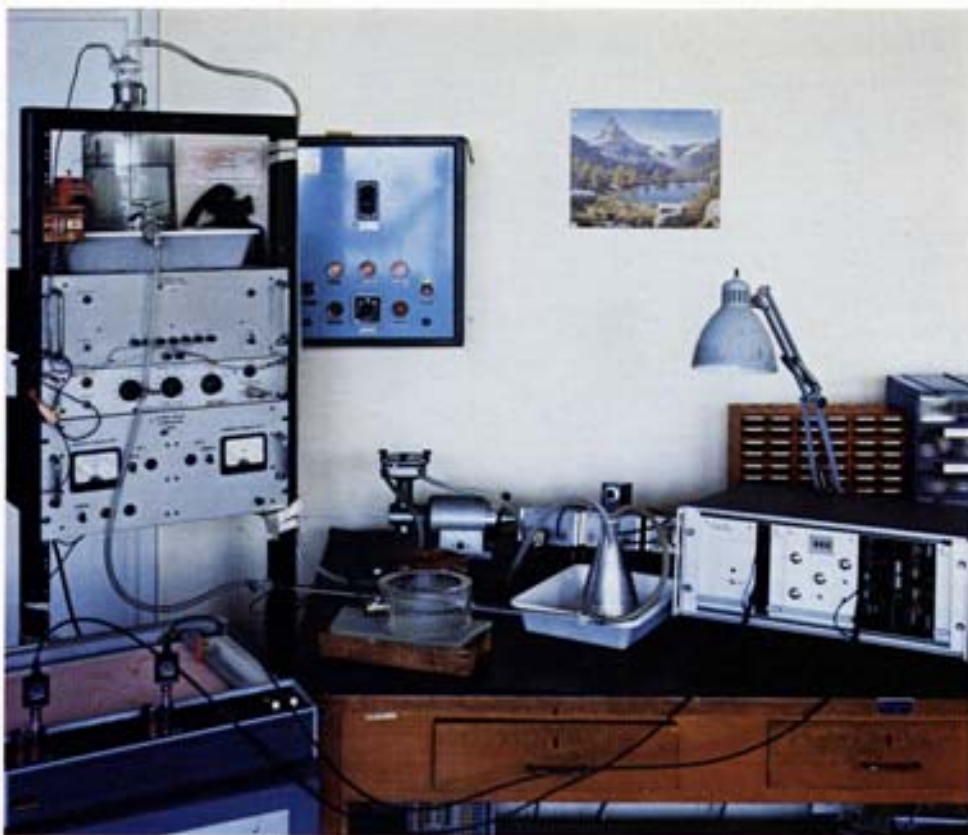
Fig. 95 - Apparecchiatura ad ultrasuoni per la rivelazione con metodo non intrusivo di profili di velocità del sangue in grossi vasi nell'uomo, sia in modo pulsato che continuo (quindi sia in arterie che in vene). Esso consente di rivelare anomalie funzionali nella circolazione sanguigna.
