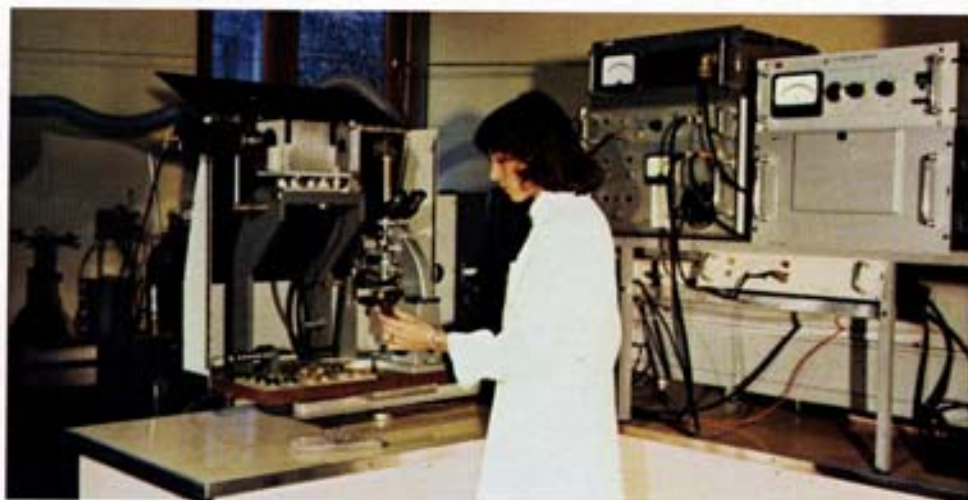
Fig. 116 - Microsonda laser-spettrografica impiegata per analisi non distruttive di campioni di diversa natura. Tale apparecchiatura consente di analizzare zone ristrette, dell'ordine dei \mu\text{m} , senza trattamento preliminare dei campioni. Viene altresì impiegata per indagini di carattere metallurgico sulla struttura e condizioni morfologiche dei materiali.
