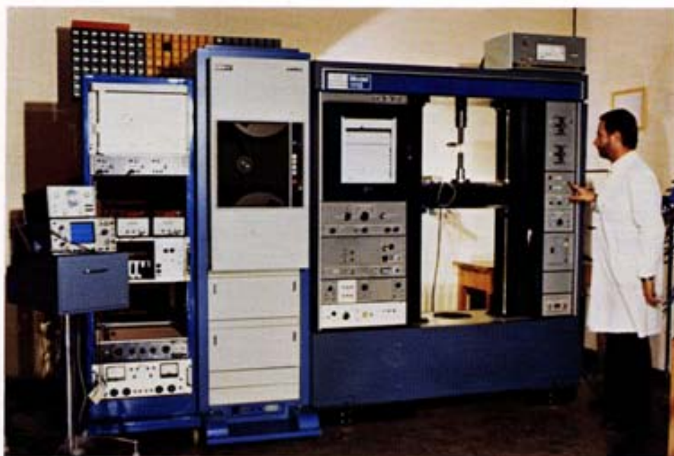
Fig. 71 - Sistema di apparecchiature mediante il quale si fanno indagini sulla correlazione tra le proprietà meccaniche dei materiali - in particolare degli acciai per recipienti a pressione nucleari - e le caratteristiche dei segnali di emissione acustica rilevati durante le prove di trazione, di torsione e di meccanica della frattura. A destra, è visibile la macchina Instron per prove sui materiali, da 10 t; a sinistra, l'apparecchiatura per il condizionamento e l'amplificazione dei segnali di emissione acustica; al centro, il registratore magnetico Ampex 3000 a 14 tracce, per la registrazione simultanea di tutti i dati rilevati.
