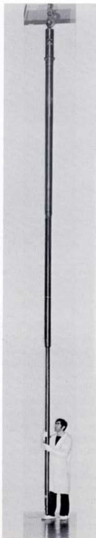
Fig. 34 - Il tubo a pressione visibile in fig. 32 è alloggiato nel tubo di sicurezza mostrato in questa figura, la cui funzione è quella di contenere le conseguenze dell'eventuale massimo incidente credibile che coinvolgesse la sezione di prova ed il tubo a pressione stesso.
