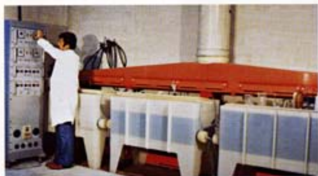
Fig. 69 - Vasche in moplén per trattamenti di sgrassaggio, decapaggio e passivazione di materiali metallici diversi (alluminio, acciai inossidabili, Zircaloy, ottoni, etc.). Tali trattamenti vengono effettuati su componenti di impianti e su campioni per prove di corrosione.
