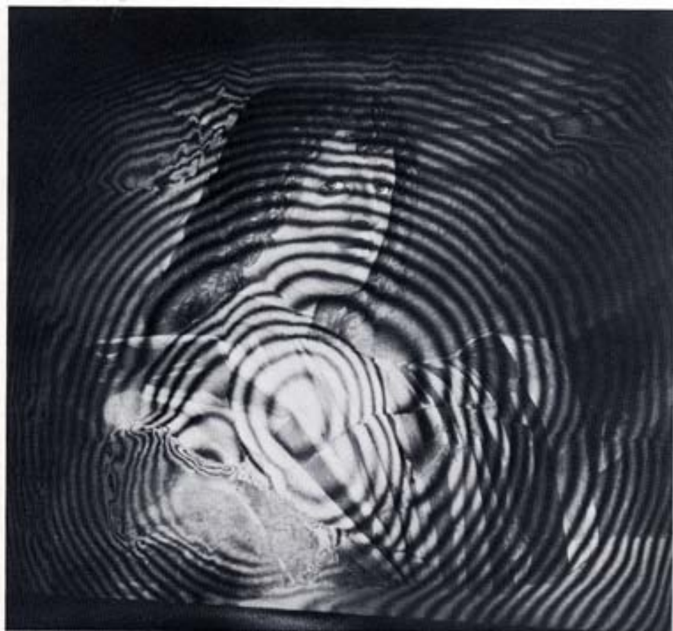
Fig. 111 - Fotografia di un ologramma a doppia esposizione dell'affresco visibile nella fig. 108, registrato con l'apparecchiatura mostrata nella fig. stessa. L'esame del sistema di frange presente nell'immagine ricostruita dall'ologramma, riportata nella foto, ha consentito di mettere in evidenza la presenza di distacchi dal supporto e di altre lesioni del dipinto. Informazioni di questo tipo relative ad opere d'arte sono utili sia per decidere interventi di restauro, sia per verificare a posteriori la correttezza degli interventi stessi.
