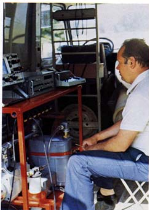
Fig. 123 - Particolare dell'interno dell'automezzo FIAT-242 attrezzato per misure in campo di radioattività naturale e artificiale. In particolare, la strumentazione visibile nella foto serve alla determinazione della concentrazione in aria del rado-222, radioisotopo della famiglia dell'uranio naturale.
