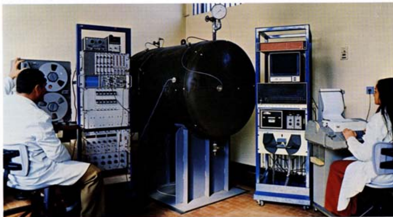
Fig. 56 - Strumentazione del sistema di misura dei segnali di emissione acustica prodotti da un recipiente a pressione nel corso di una prova a pressione idrostatica. Si notano i sensori di emissione acustica applicati al recipiente stesso.
