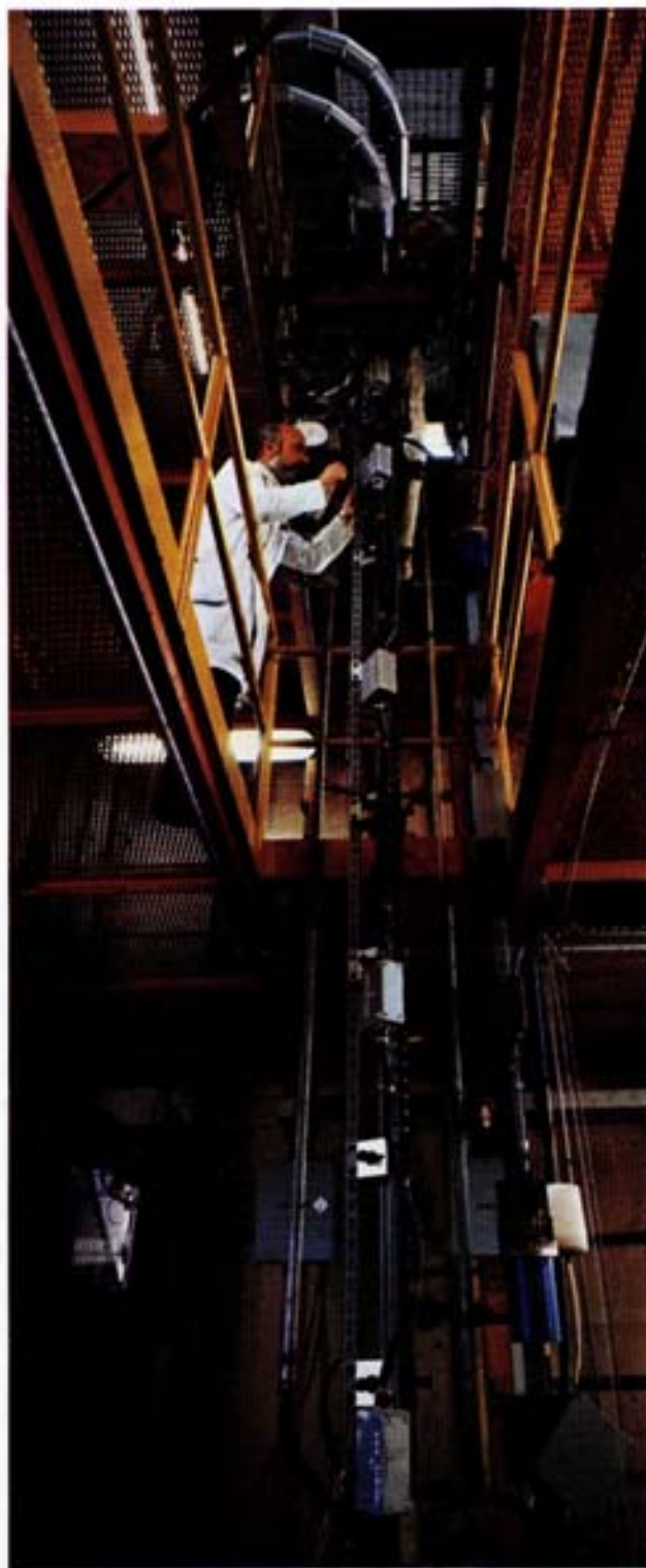
Fig. 9 - Circuito IETI-1 (Impianto Esperienze Termoidrauliche-1), per esperienze termoidrauliche su piccola scala con acqua bollente o in pressione, sia in condizioni stazionarie che in transitorio. È situato presso la Centrale termoelettrica Emilia dell'ENEL di Piacenza. Nella foto, è visibile il tratto del circuito in cui vengono inseriti gli elementi di prova (anuli o tubi) che simulano le barre di combustibile.
