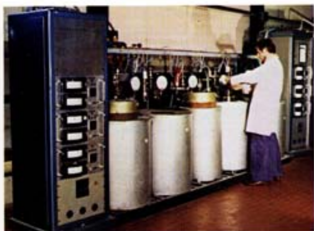
Fig. 65 - Batteria di autoclavi in acciaio inossidabile, per prove di corrosione, fretting corrosion e stress corrosion in acqua o vapore, con o senza additivi, fino a temperatura di 500 °C e pressione di 150 kg/cm 2 . Le prove riguardano materiali diversi, come Zircaloy, Inconel, acciai austenitici e martensitici, e giunzioni tra materiali diversi (Zircaloy-2/acciaio inossidabile, Zircaloy-2/platino, etc.).
