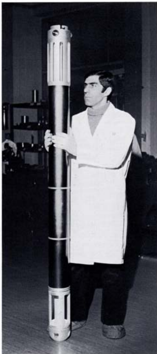
Fig. 47 - Dispositivo Commode-3 per l'irraggiamento in reattore di provini o spezzoni di materiali strutturali da sottoporre a caratterizzazione. In particolare, la foto riguarda la preparazione di un'esperienza su spezzoni del tubo di isolamento, contenenti nel loro interno spezzoni di tubo a pressione del CIRENE. Tali spezzoni sono impilati sull'anima interna del dispositivo e tenuti insieme dalle due estremità dello stesso. Dopo irraggiamento essi sono destinati ad essere sottoposti a prove di scoppio. Gli irraggiamenti vengono effettuati nel reattore ESSOR del Centro Euratom di Ispra.
