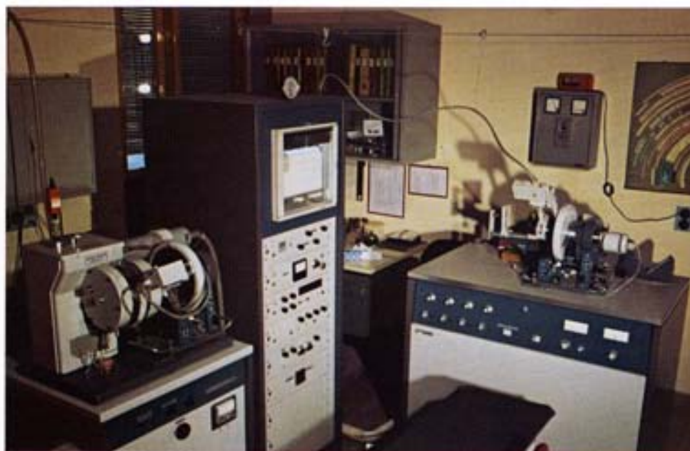
Fig. 117 - Apparecchiature a raggi X, utilizzate sia per analisi cristallografiche mediante diffrazione X, sia per analisi di composizione elementare mediante spettrometria di fluorescenza X.
