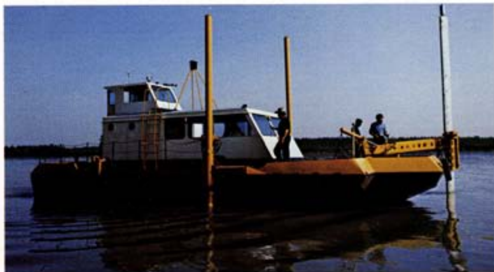
Fig. 126 - Il natante PANDORA, attrezzato per le ricerche sull'alterazione termica delle acque fluviali dovuta agli scarichi caldi delle centrali elettriche. In particolare, esso viene utilizzato in corrispondenza degli scarichi delle centrali dell'ENEL localizzate sulle rive del Po. È visibile a prora la sonda automatizzata porta-trasduttori per la rilevazione delle distribuzioni di temperatura e di velocità delle acque. A bordo è installato un minicalcolatore per l'elaborazione immediata dei dati rilevati.
