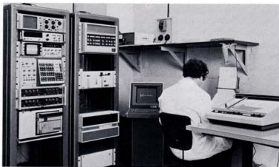
Fig. 54 - Apparecchiatura per l'analisi spettrale di vibrazioni di strutture, impiegante un minicalcolatore da 32 K parole di memoria, predisposto come analizzatore di Fourier.
