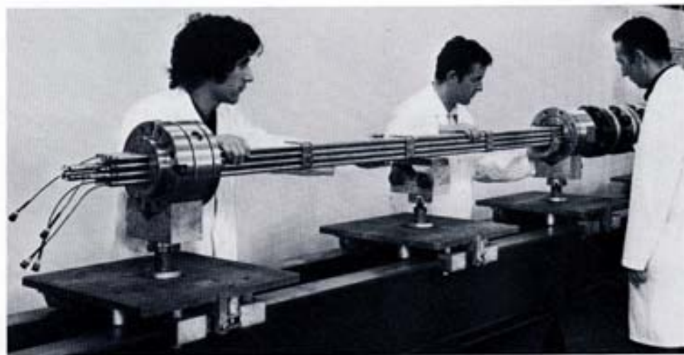
Fig. 17 - Elemento di prova a fascio di 16 barre (tubolari) che simula un canale di potenza BWR con relative testate (il tubo a pressione è stato tolto per rendere visibile il fascio). Elementi di questo tipo vengono impiegati per esperienze di potenza critica e di svuotamento. La generazione di potenza viene ottenuta per effetto Joule, alimentando ciascuna barra con corrente continua. Le barre sono strumentate internamente con termocopie.
