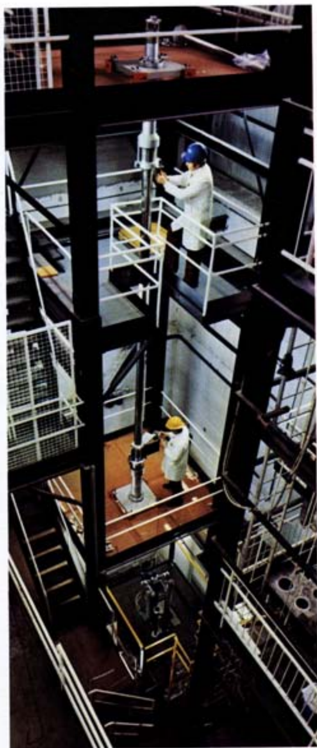
Fig. 77 - Attrezzatura per la messa a punto del processo di fabbricazione in sito delle giunzioni mandrinate dei tubi di calandria (di isolamento, di arresto rapido e strumentati) del reattore CIRENE (v. fig. 73). L'attrezzatura è dotata di due macchine per la mandrinatura, una superiore ed una inferiore (v. le due figg. successive) e riproduce le condizioni geometriche proprie del reattore: in particolare, essa misura circa 25 m di altezza.
