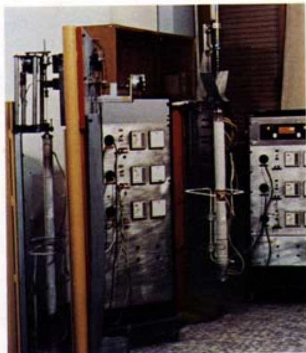
Fig. 86 - Apparecchiature per la crescita di monocristalli di tellururo di cadmio e mercurio ((HgCd)Te). Sono visibili i due forni a tre stadi regolati indipendentemente, così da permettere un predeterminato profilo di temperatura (in particolare, i profili tipici dei sistemi a zona fusa ed a Bridgman, cioè a fusione totale).
