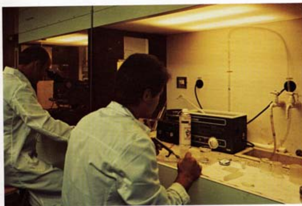
Fig. 93 - L'intero processo fotolitografico con cui vengono realizzati i dispositivi a semiconduttore, partendo dalle maschere ottenute con l'attrezzatura visibile nella fig. precedente, viene svolto nelle cappe mostrate in questa figura, situate entro una camera gialla depolverizzata. La luce gialla è richiesta per non impressionare le sostanze fotosensibili.
