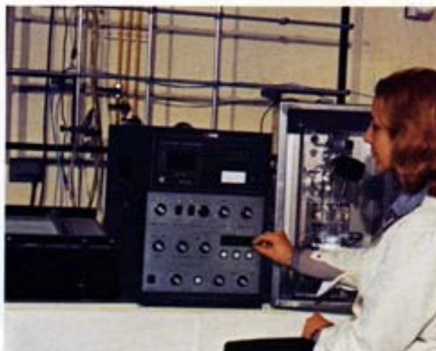
Fig. 124 - Strumento Coulter Counter per il conteggio e la determinazione della distribuzione granulometrica di particelle sospese in acqua o altro liquido. Esso è in grado di fornire in pochi minuti la distribuzione granulometrica e la concentrazione di particelle con diametri anche inferiori al \mu\text{m} . È stato impiegato nello studio del materiale sospeso nei fiumi e di pigmenti per vernici.
