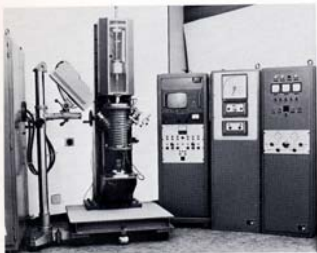
Fig. 85 - Apparecchiatura per la crescita di monocristalli con metodo Chzocralski (v. anche fig. 80). Il crogiuolo è contenuto in una camera per alta pressione (fino a 200 kg/cm 2 ). Il controllo delle diverse fasi di crescita dei monocristalli viene perciò effettuato a distanza, mediante la telecamera visibile in figura. A destra sono visibili gli altri sistemi di controllo del processo.
