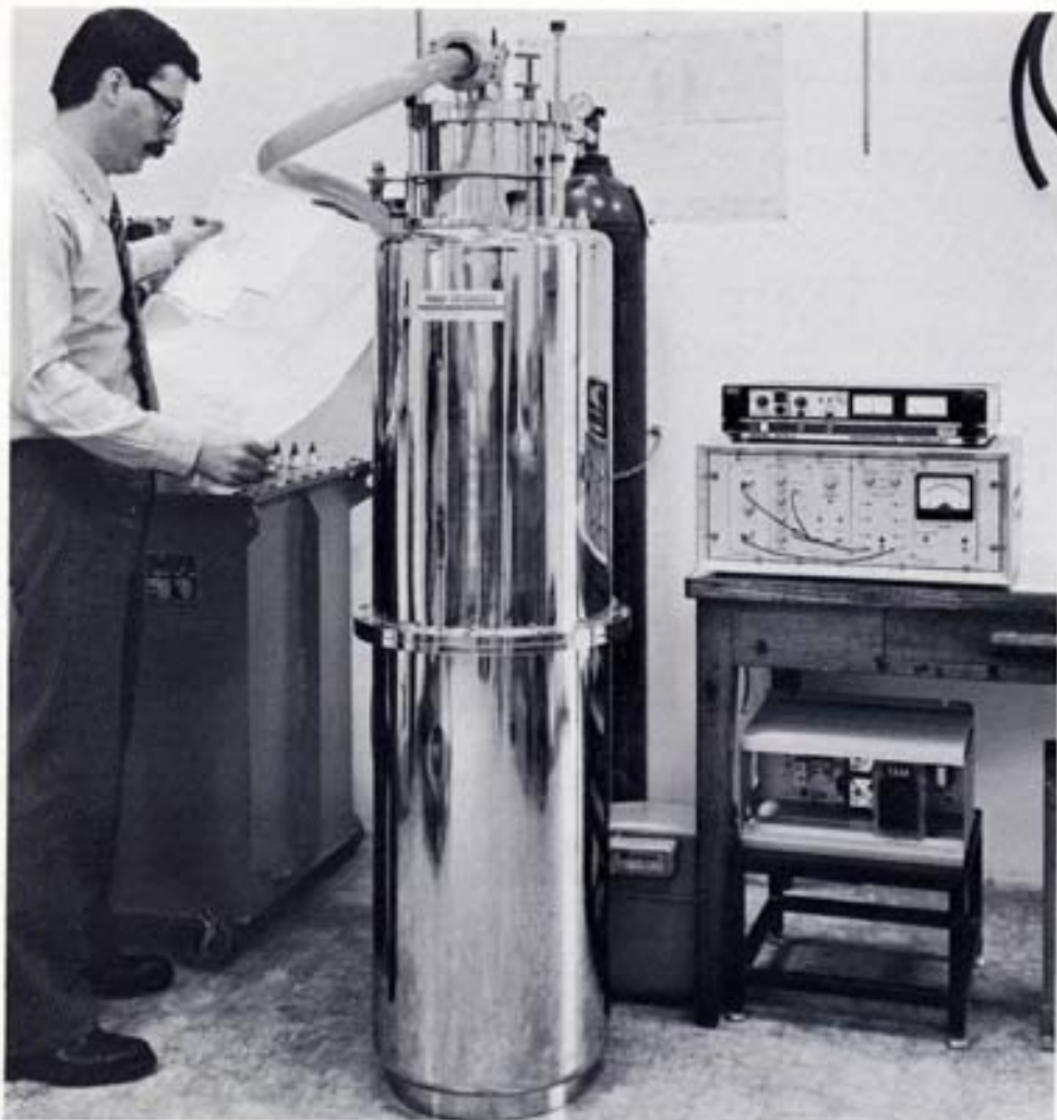
Fig. 132 - Criostato prototipo realizzato dalla Thor-Cryogenics (G. B.) in collaborazione col CISE. Esso viene utilizzato per lo studio del comportamento di materiali superconduttori nuovi o poco noti, a temperature tra 4 e 77 K e percorsi da correnti (8000 A). A destra del criostato si nota un microwattmetro sviluppato espressamente al CISE per la misura delle potenze dissipate da una bobina superconduttrice.
