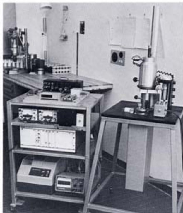
Fig. 48 - Per la misura dei diametri e la rilevazione dei profili della sezione normale di barre di combustibile CIRENE sottoposte a condizioni di prova fuori o in reattore, sono state realizzate due versioni di un'apparecchiatura analogica, denominata PROBA (PROfilo BARre). La foto rappresenta la versione che opera su materiale non irraggiato; l'altra, che opera su materiale irraggiato, è installata in cella calda presso il Centro Euratom di Ispra.
