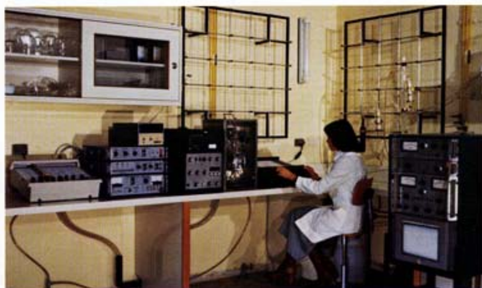
Fig. 66 - Laboratorio di elettrochimica, in cui si effettuano ricerche sulla corrosione a temperature non elevate di materiali per impiego in condensatori e circuiti di raffreddamento di impianti termoelettrici, in rivestimenti di dighe, etc..
