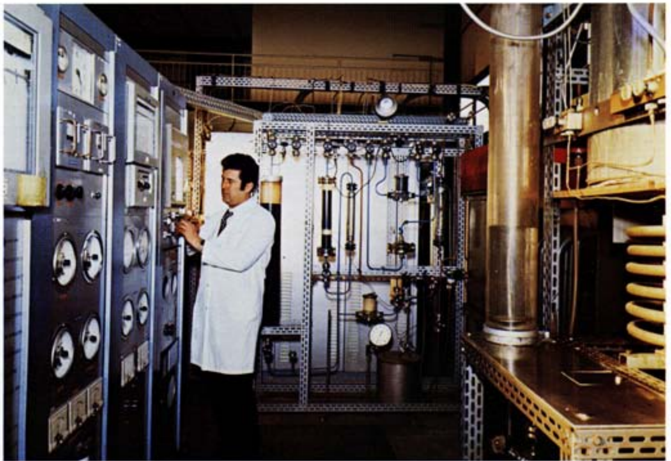
Fig. 64 - Circuito HECO-1 (Heat Exchanger CORrosion-1), impiegato per prove di corrosione, anche in condizioni di scambio termico, su materiali per impieghi nucleari (Zircaloy, Inconel, etc.) e convenzionali (acciai al carbonio, acciai inossidabili, etc.); in esso sono possibili il controllo in continua delle caratteristiche chimico-fisiche dei fluidi circolanti (soluzioni acquose) e l'aggiunta di additivi ed impurezze per simulare le condizioni reali di impiego dei materiali in prova.
