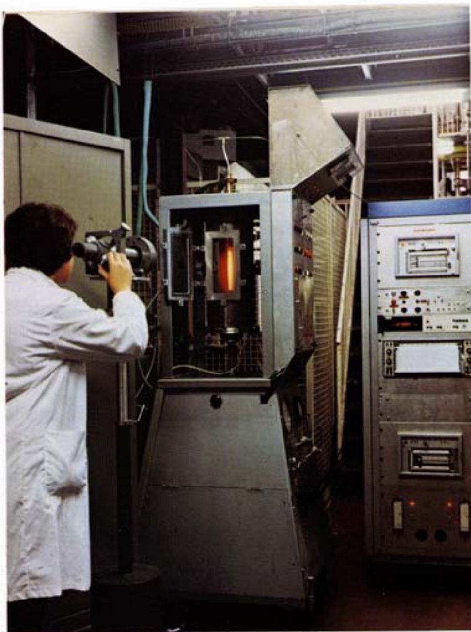
Fig. 39 - Apparecchiatura BOA I (Ballooning Onset Assembly I), impiegata per studi sul comportamento termomeccanico (creep ad alta temperatura) delle guaine delle barre di combustibile in condizioni di incidente LOCA (a temperatura fino a 1200 °C). Lo spezzone di guaina in prova, visibile nella foto all'interno della camera di prova attraverso lo sportello appositamente aperto, è riscaldato per effetto Joule.
