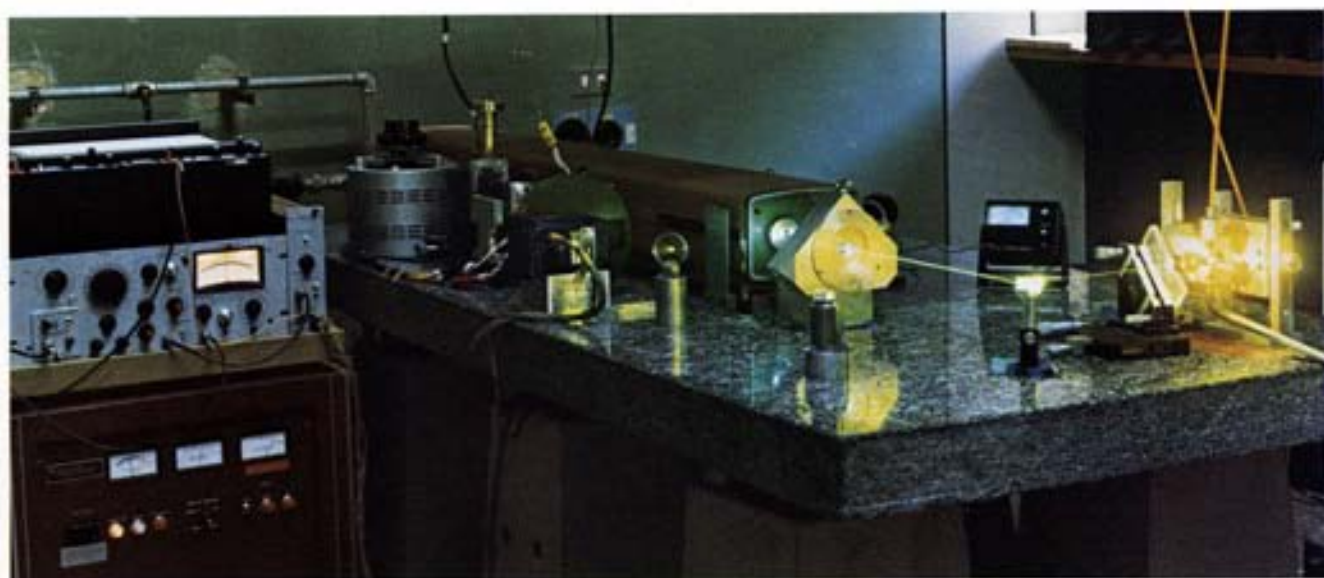
Fig. 99 - Generazione di radiazione continua infrarossa coerente, accordabile nella regione 2-4 \mu\text{m} , ottenuta mescolando in un cristallo di niobato di litio un fascio di laser ad argo con quello di un laser a coloranti accordabile nel visibile. La frequenza della radiazione ottenuta è la differenza tra quella dei due fasci. Questa apparecchiatura viene utilizzata per misure di spettroscopia lineare ad alta risoluzione.
