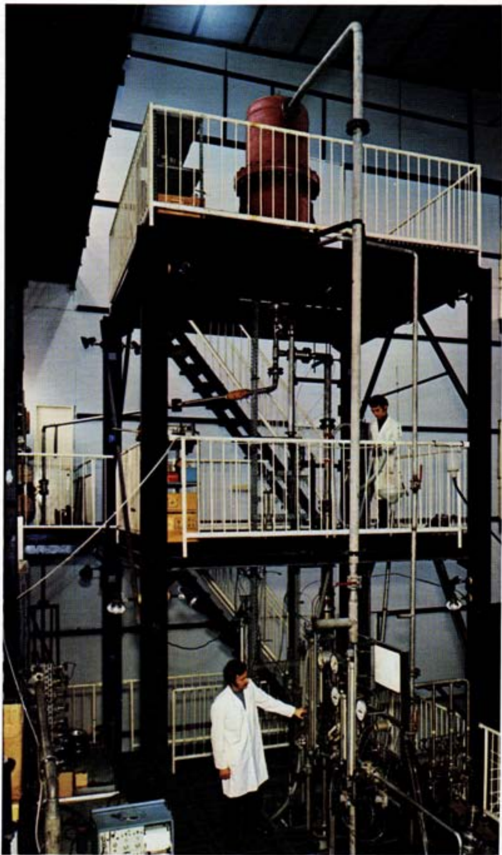
Fig. 8 - Circuito IDRA (IDRodinamica Adiabatica) per esperienze di fluidodinamica (misure di perdite di carico e frazioni di vuoto, taratura di strumenti di misura, ecc.) con miscele a due componenti a temperatura ambiente in condizioni stazionarie. Il circuito è stato anche utilizzato per lo studio dell'elemento di combustibile CIRENE.
