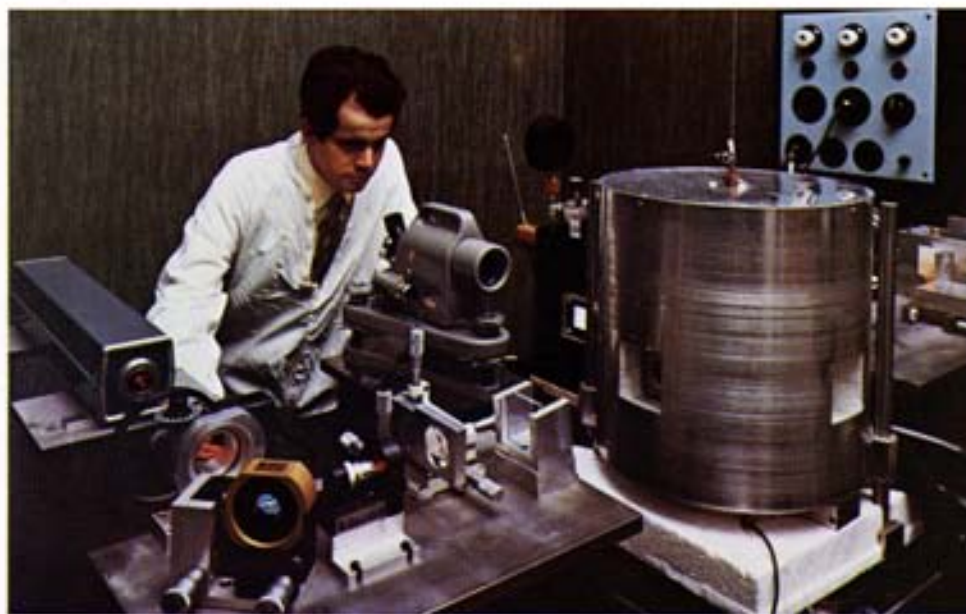
Fig. 107 - Apparecchiatura laser per l'analisi delle instabilità termoidrauliche in miscele liquide e la misura dei coefficienti di diffusione con metodi di deflessione del fascio di luce laser. L'apparecchiatura consente anche di determinare le variazioni di grandezze termodinamiche in prossimità dei punti critici delle transizioni di fase in miscele a più componenti. Questa tecnica potrebbe essere particolarmente utile nei processi di separazione isotopica, di distillazione frazionata e, come alternativa alle tecniche attuali, nella strumentazione biomedica.
