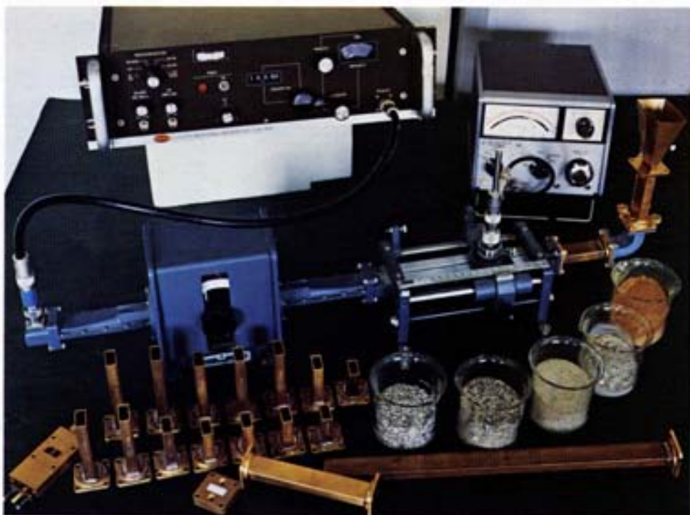
Fig. 96 - Prototipo di un'attrezzatura per la determinazione mediante microonde dell'umidità di terre e sabbie. Essa sfrutta il diverso comportamento di questi materiali, a seconda del loro grado di umidità, quando sono inseriti in una cavità per microonde. Queste misure sono di grande utilità per il controllo dei materiali da costruzione e dell'umidità dei terreni nelle dighe.
