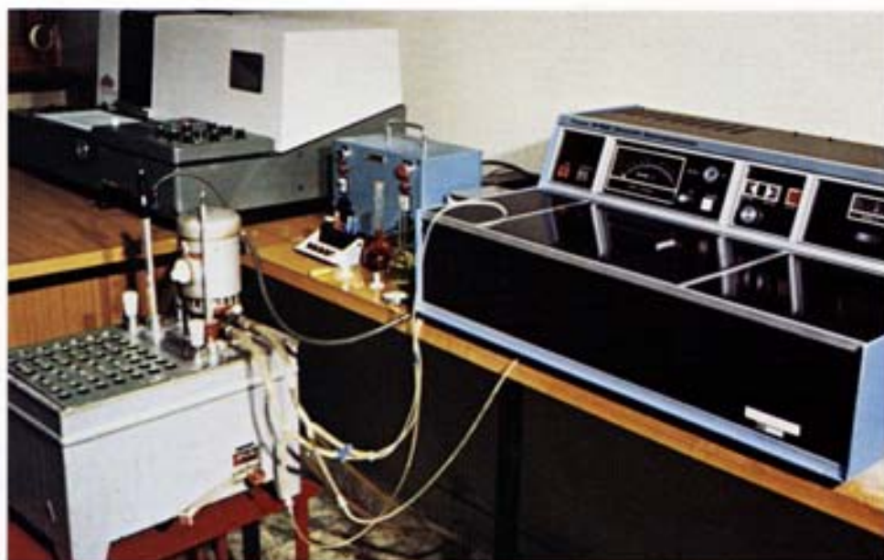
Fig. 115 - Strumentazione per analisi chimiche spettrofotometriche: in primo piano, uno spettrofotometro a doppio raggio per misure nell'ultravioletto e nel visibile con campioni termostattati; in fondo, spettrofotometro per misure nell'infrarosso.
