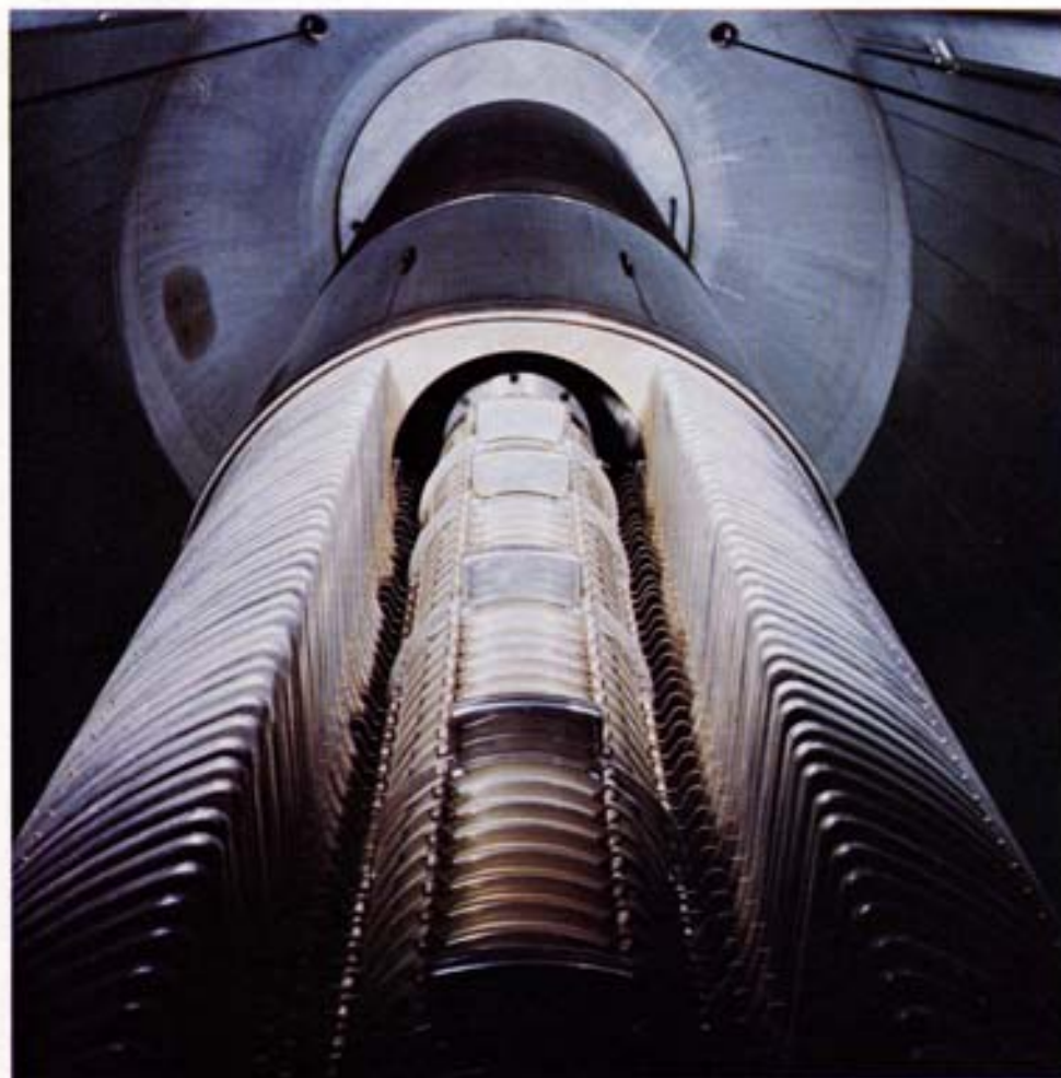
Fig. 127 - L'acceleratore Tandem Van de Graaff, progettato e costruito interamente dal CISE, consente di ottenere fasci di protoni e deutoni da 7 MeV, e di ioni più pesanti, in particolare particelle \alpha e ioni ossigeno. Oltre che per misure di fisica di base, esso si presta per utilizzazioni nei campi della microanalisi, dell'ingegneria nucleare, della fisica dei materiali. La foto mostra l'interno del contenitore a pressione; si notano l'elettrodo ad alta tensione con le colonne di piatti equipotenziali e, al centro, il tubo acceleratore.
