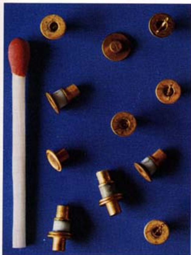
Fig. 87 - Diodi Gunn utilizzati come generatori di microonde e parti dei loro contenitori (basette e cappucci). All'interno di alcune basette sono già montati i diodi stessi. Questi ultimi hanno dimensioni di qualche decimo di mm. Le dimensioni dei contenitori si rilevano dal confronto col fiammifero.
