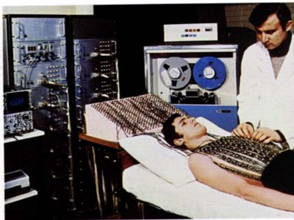
Fig. 94 - Apparecchiatura per la rilevazione del potenziale cardiaco. Il potenziale viene misurato in 240 punti del torace, alla velocità di 120 000 dati al secondo. Tali dati, elaborati mediante calcolatore, forniscono informazioni sull'evoluzione spazio-temporale dell'attività elettrica del cuore, che consentono la diagnosi di cardiopatie non rivelabili con i comuni elettrocardiografi.
