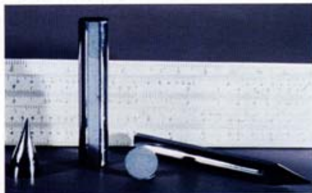
Fig. 81 - Monocristalli di tellurio di cadmio e mercurio ((HgCd)Te), cresciuti con il metodo a zona fusa mediante una delle apparecchiature mostrate in fig. 86. La forma esterna dei lingotti mostrati nella figura corrisponde a quella della provetta di quarzo in cui il materiale di partenza è stato posto. Questi monocristalli sono stati utilizzati per la preparazione di rivelatori per l'infrarosso (v. fig. 88).
