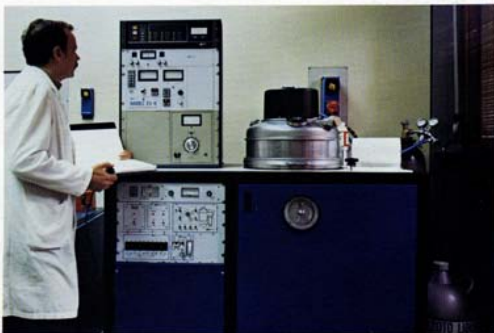
Fig. 129 - Evaporatore Airco-Temescal: una apparecchiatura commerciale altamente sofisticata per evaporare metalli e materiali refrattari, mediante bombardamento elettronico (il fascio ha la potenza di 8 kW), in condizioni di estrema purezza (vuoto limite, 10^{-6} torr). Esso viene utilizzato per la deposizione di strati sottili su supporti eterogenei per applicazioni ottiche, elettroniche, elettroottiche e di fisica delle superfici e dello stato solido.
