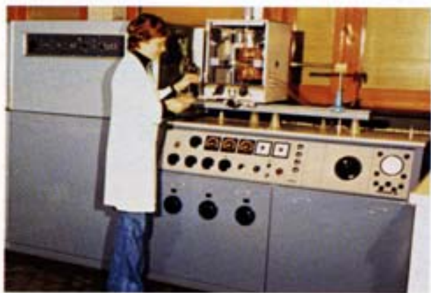
Fig. 114 - Spettrografo di emissione ottica, impiegato presso il laboratorio di spettrografia per l'analisi di elementi in tracce in matrici differenti.
