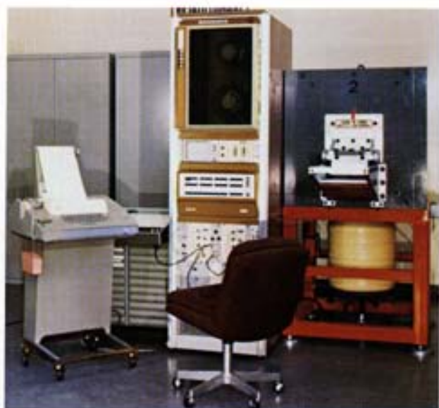
Fig. 120 - Sistema Plurimat 20 Intertechnique per l'acquisizione e l'elaborazione automatica di spettri \gamma di campioni a bassa radioattività, eseguiti con rivelatori ad alta risoluzione. A destra dell'apparecchiatura è visibile il contenitore con pareti di ferro, spesse 15 cm, che serve a schermare dalle radiazioni naturali il rivelatore a Ge(Li) ed il campione da analizzare. Il sistema viene usato per spettrometria \gamma diretta di campioni di origine ambientale.
