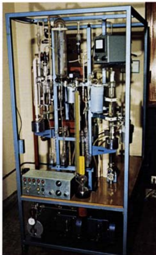
Fig. 63 - Apparecchiatura per l'analisi del tenore di idrogeno nei metalli mediante estrazione a caldo sotto vuoto. È stata impiegata prevalentemente per l'analisi della quantità di idruri contenuti nelle leghe di zirconio.
