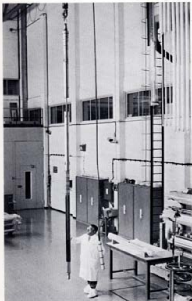
Fig. 30 - Per la sperimentazione in reattore dell'elemento di combustibile CIRENE (v. fig. precedente), mediante l'impianto CART-TC (v. fig. 42), sono state sviluppate numerose sezioni di prova, delle quali la più sofisticata è quella tipo C-3 (CART-3), mostrata in figura. Caratteristiche peculiari di queste sezioni sono date dalla possibilità di rilevare la temperatura di guaina dei fasci di combustibile durante l'irraggiamento e di consentire la permutazione dei fasci per avere un tasso di bruciamento (burn-up) uniforme.
