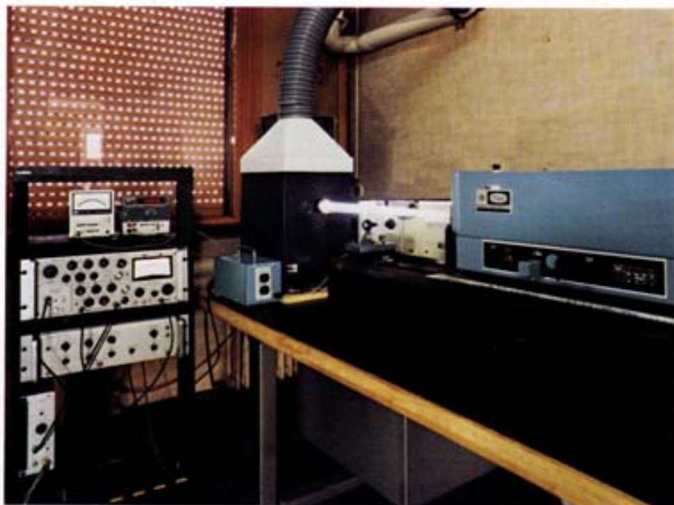
Fig. 91 - Catena di misura impiegata per valutare la sensibilità a diverse lunghezze d'onda (della luce incidente) delle celle solari ad arseniuro di gallio (GaAs) ed arseniuro di gallio e alluminio ((GaAl)As).
