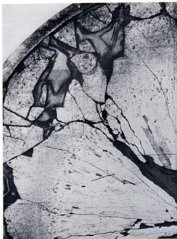
Fig. 36 - Esperienze di irraggiamento sul combustibile CIRENE: macrografia della sezione trasversale di una paglia di combustibile irraggiata.
