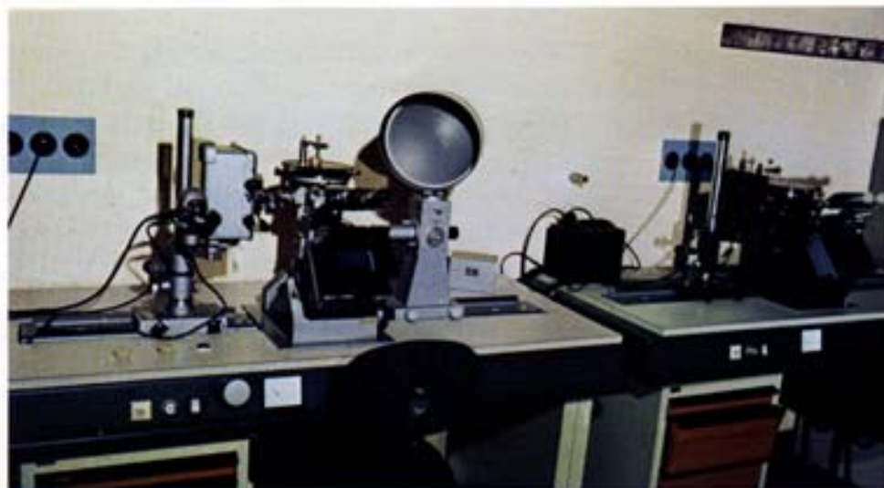
Fig. 59 - Microscopi metallografici, con cui si effettuano esami sulla microstruttura di metalli e leghe, sia per qualificarli, sia per rilevare fenomeni indotti da trattamenti termici, meccanici, chimici.
