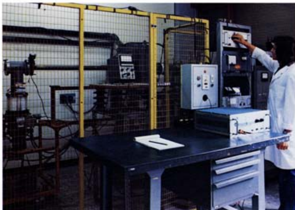
Fig. 90 - Apparecchiatura per l'impiantazione di ioni, realizzata al CISE quando ancora non erano reperibili sul mercato apparecchiature similari. Essa è essenzialmente costituita da un dispositivo per la produzione di ioni, da un selettore magnetico e da un acceleratore elettrostatico. È stata utilizzata per la realizzazione di rivelatori per l'infrarosso.
