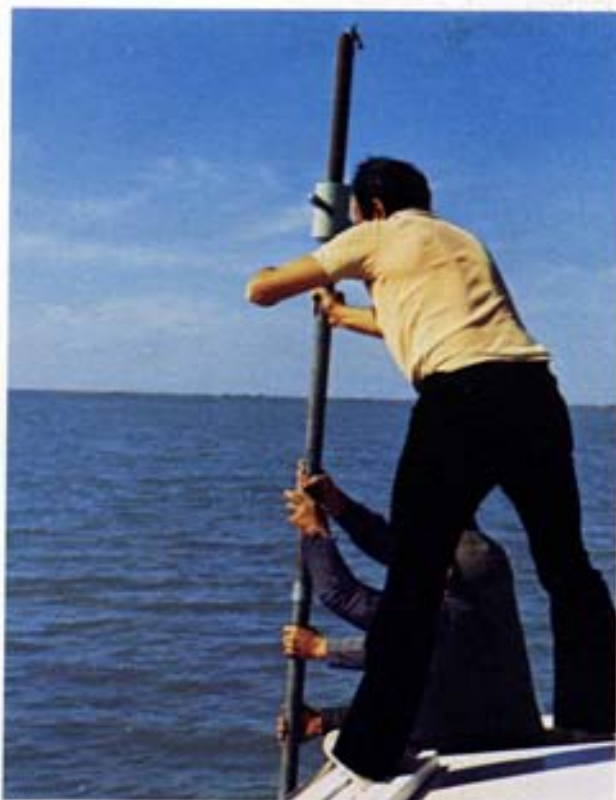
Fig. 125 - Prelievo di una carota di sedimento marino in una zona a basso fondale. Analizzando la stratificazione di particolari elementi radioattivi naturali (piombo-210, polonio-210) o artificiali (cesio-137) è possibile valutare la velocità di sedimentazione sul fondale.
