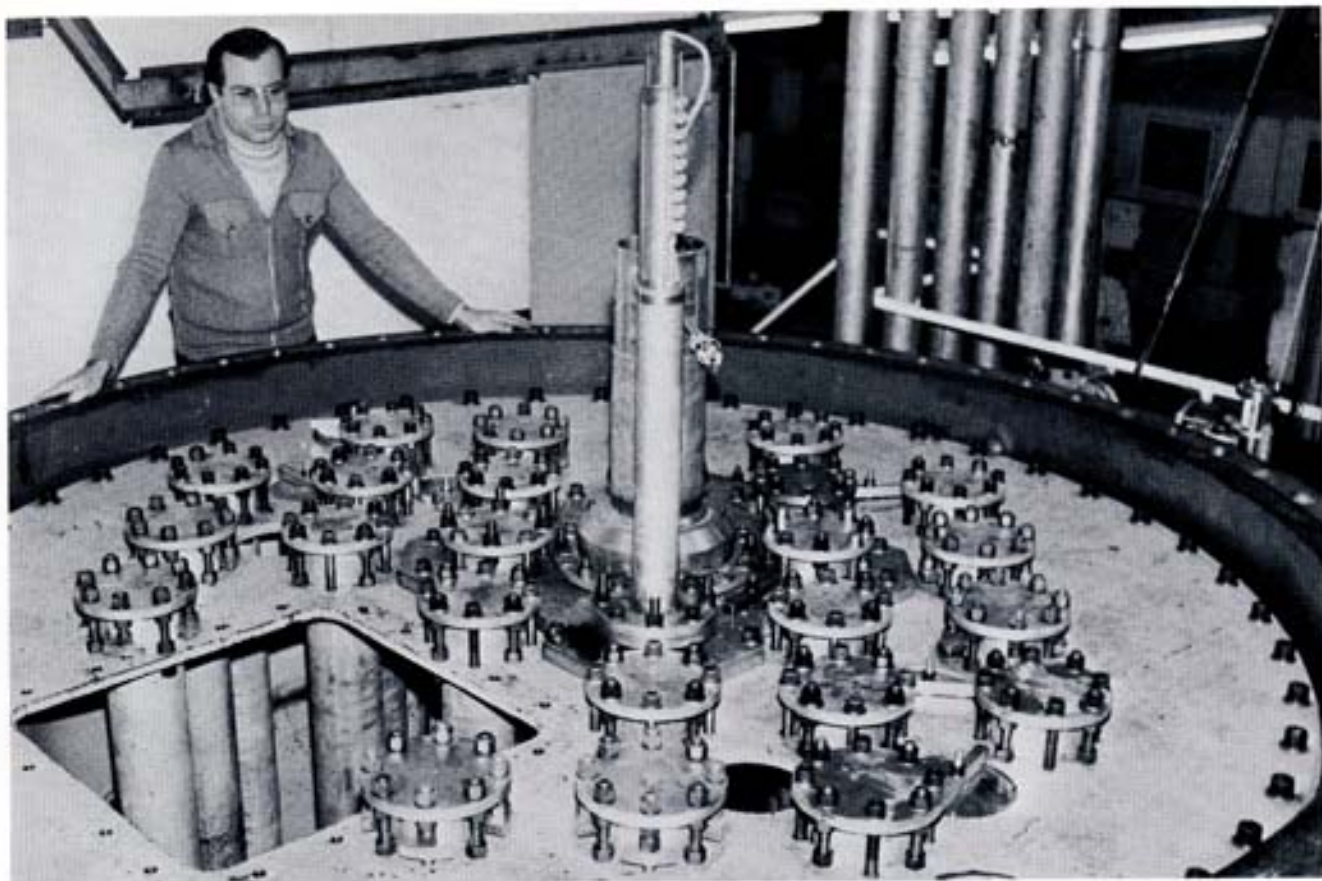
Fig. 27 - L'impianto BETULLA, situato presso il Centro Euratom di Ispra, è utilizzato per esperienze di scoppio del tubo a pressione del reattore CIRENE (esperienze miranti a determinare gli effetti di un incidente di quel tipo sulla struttura del nocciolo del reattore stesso). Tale incidente, quantunque ritenuto pressoché impossibile, viene ugualmente preso in considerazione nelle analisi di sicurezza del reattore. La foto mostra la piastra superiore del recipiente a pressione che simula la vasca del moderatore del CIRENE; sono visibili le estremità degli elementi passivi del reticolo e, al centro, la parte superiore dell'elemento di scoppio e quella dell'elemento strumentato.
