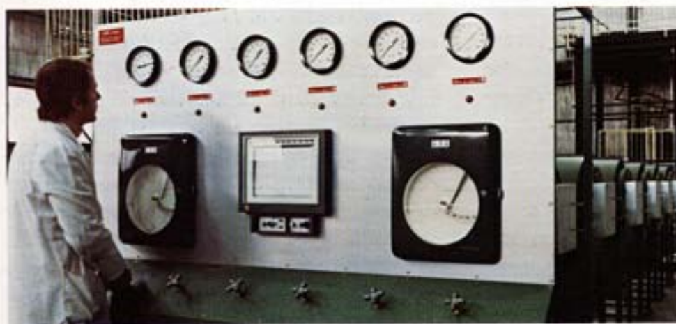
Fig. 75 - Impianto per lo studio delle caratteristiche di tenuta delle giunzioni mandrinare del tubo a pressione del reattore CIRENE mediante prove a lungo termine a pressione e temperatura (v. fig. 73). L'impianto è costituito di sei unità, e consente quindi di provare contemporaneamente sei campioni a doppio giunto.
