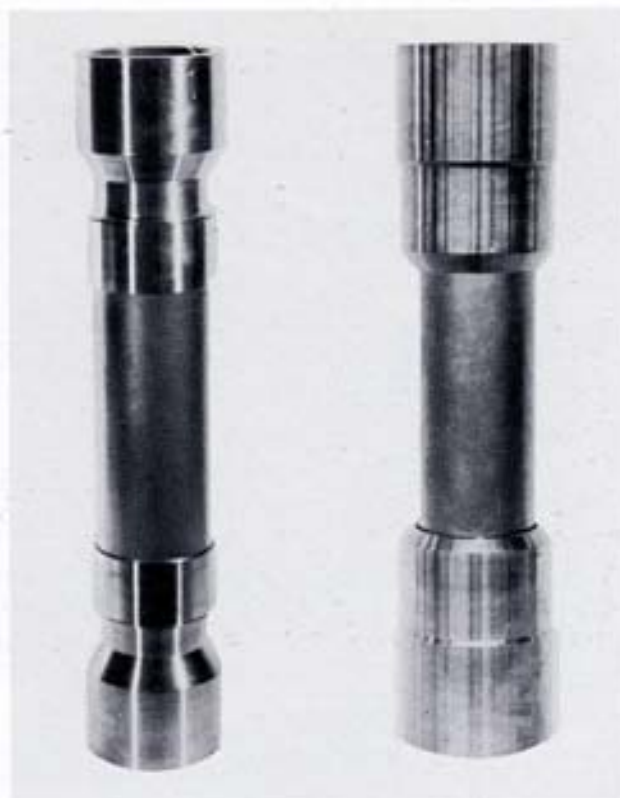
Fig. 73 - Esempari di giunzioni mandrinate: quella a sinistra, del tipo a « sandwich », è utilizzata per la transizione Zircaloy-2/acciaio nella parte superiore del tubo a pressione CIRENE; quella a destra, del tipo « convenzionale », è utilizzata per detta transizione nella parte inferiore del tubo stesso. La giunzione a sandwich differisce essenzialmente da quella convenzionale per il fatto che in essa lo Zircaloy si trova compresso tra l'acciaio del prolungamento di estremità del canale ed un anello esterno pure in acciaio.
