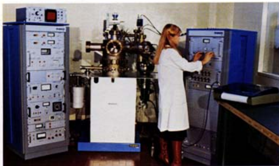
Fig. 68 - Apparecchiatura SIMS (Secondary Ion Mass Spectrometer) impiegata negli studi sugli attriti e l'adesione di materiali metallici; essa è in grado di analizzare strati superficiali molto sottili (dell'ordine di qualche Å) di metalli o leghe.
